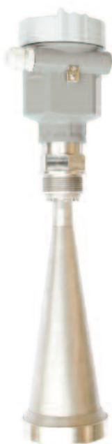
Gli RPL sono strumenti per la misura di livello senza contatto con il prodotto. Gli impulsi radar emessi dall'antenna vengono riflessi dalla superficie del prodotto e successivamente captati dall'antenna stessa. Il sistema di gestione integrato a bordo degli RPL sfrutta il tempo di volo per ricavare la distanza della superficie del prodotto dalla sonda e, di conseguenza, il livello.
