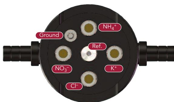
Particolare attenzione è stata posta nell'individuare un'insieme di sensori stabili e allo stesso tempo sensibili. A questo scopo è stato introdotto anche un elettrodo di riferimento particolarmente performante e con un'elevata capacità di compensazione degli inquinanti
