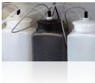
Continuo monitoraggio dei reagenti tramite sonde di livello. Il Reagente DPD in polvere da diluire prima dell'utilizzo è una ottima soluzione per conservare il prodotto in sicurezza in ogni luogo.
