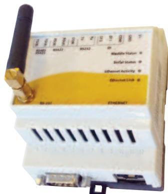
Il gateway di comunicazione si collega ai dispositivi di campo attraverso diversi metodi di connessione: seriale RS-232/485, ASCII o Modbus RTU. Il gateway invia i dati al data center cloud-based tramite Ethernet o una rete cellulare GSM / GPRS.
