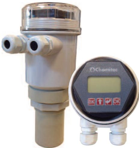
La tecnologia di misura utilizzata dal trasmettitore di livello **METER** è quella dell'emissione di un breve impulso ultrasonico. L'onda ultrasonora si propaga verso la superficie del prodotto da misurare, rimbalzando sulla sua superficie, indietro verso il sensore. L'intervallo di tempo che intercorre tra l'emissione e la ricezione dell'onda è chiamato tempo di volo ed è proporzionale alla distanza misurata, quindi al livello.
