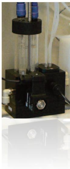
Cella di misura Fotometrica completa di scheda con interfaccia seriale RS485
