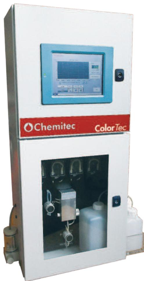
Analizzatore di parametri chimici, quali Al,  $\text{NH}_4^+$ ,  $\text{Cr}^{+6}$ ,  $\text{PO}_4^{3-}$ , Fe, Mn,  $\text{SiO}_2$  e altri su richiesta.
