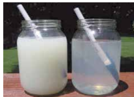
Acqua di un sistema a coat trasparente all'acqua, trattata con programma convenzionale La stessa acqua trattata con programma APEX
