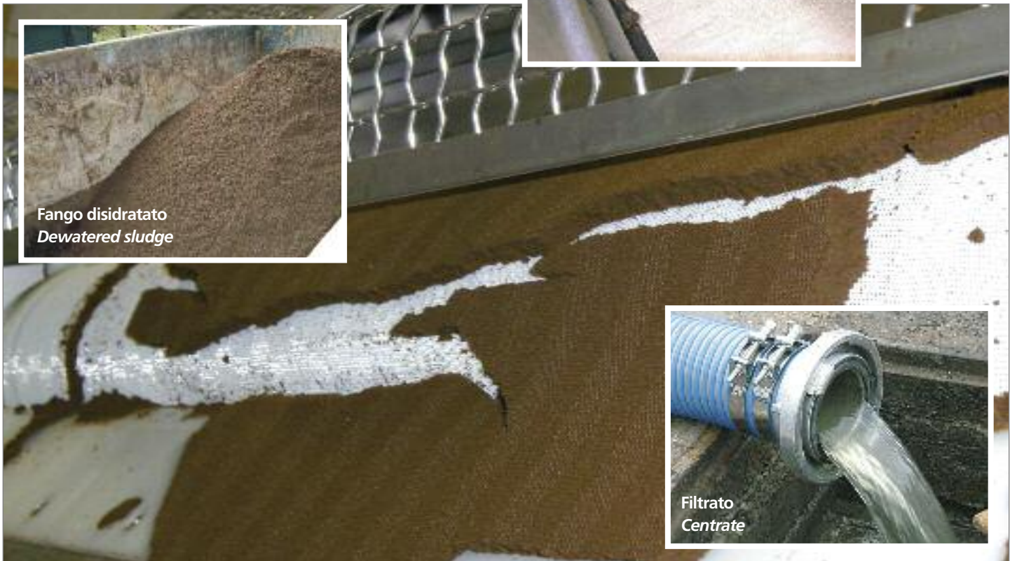
Fango in uscita dalla nastropressa Sludge leaving the belt filter press
